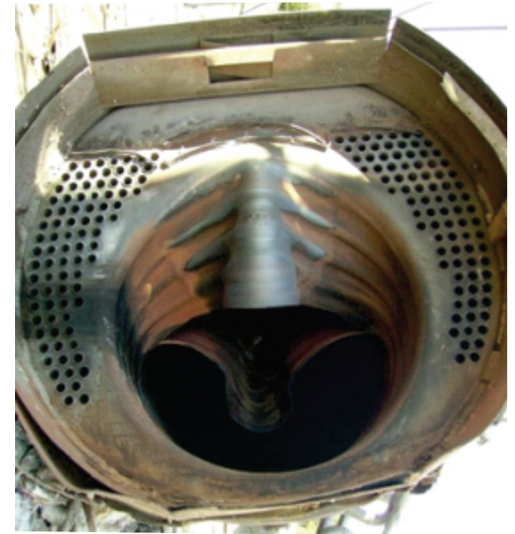
Figura 02 – Resultado de explosão de uma caldeira por falta de água (Fonte: Autor).
