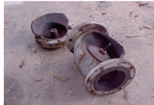
Figura 11 – Válvula globo rompida devido a golpe (Fonte: Spirax Sarco)
