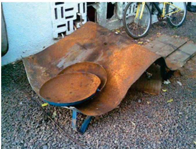
Figura 03 – Reservatório rompido (Fonte: Autor)
