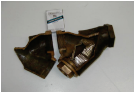
Figura 10 – Filtro Y rompido devido a golpe (Fonte: Spirax Sarco)
