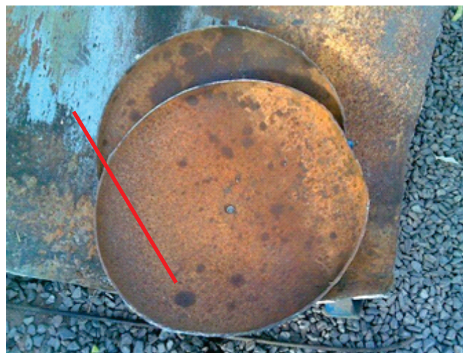
Figura 04 – Tampo do reservatório com a marca de “água”
